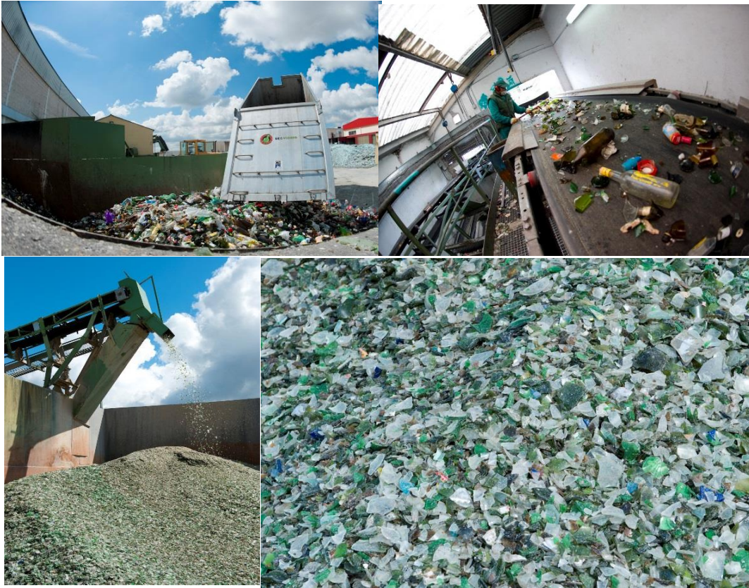
Imagen 6. 7 Proceso de descarga, cinta transportadora y calcín obtenido 63 .
